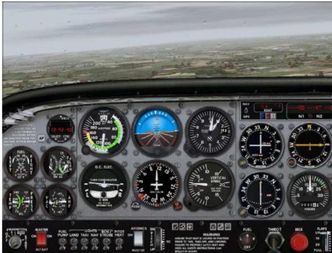
Fig. 32 : Illustration de l'interface du simulateur de vol. L'appareil piloté durant l'expérimentation est un Cessna C172 skyhawk, avion léger très répandu dans l'AG.
