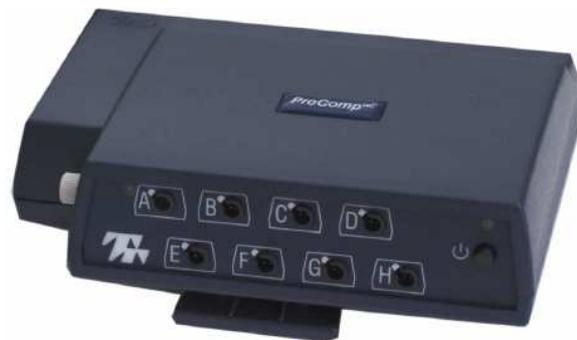
**Fig. 52 :** Illustration du *ProComp Infiniti* (©Thought Technology Ltd.) utilisé durant cette expérimentation. Il est possible de brancher jusqu'à huit capteurs en parallèle.
