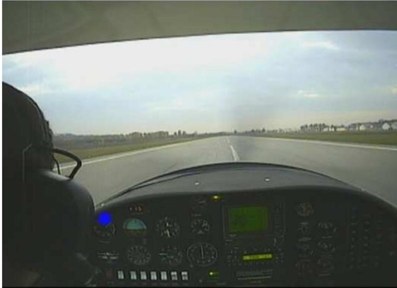
**Fig. 78 :** Le point bleu représente le point de fixation actuel du pilote. Dans la figure, celui-ci fixe l'anémomètre, instrument affichant la vitesse de l'appareil, une information capitale au moment du décollage.
